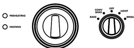
**REMARQUE :** Quand le four est allumé, le ventilateur de refroidissement se met automatiquement en marche. C'est le processus normal. Lorsque le four est éteint, le ventilateur reste en marche jusqu'à ce que la température du four descende à 163 °C (325 °F). Le ventilateur de refroidissement fonctionne également pendant l'utilisation du gril. Si le ventilateur ne tourne pas quand vous allumez le four sur ces modes, n'utilisez pas le four. Appelez un technicien qualifié pour réparer l'appareil.
